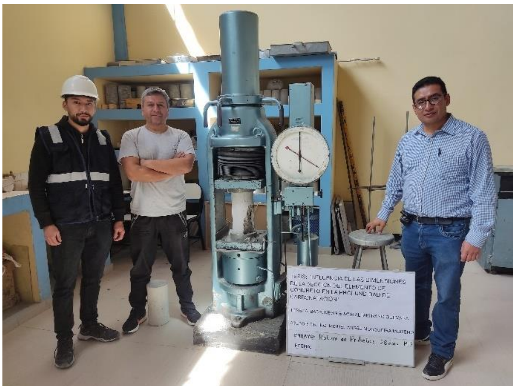
Figura 21 Ensayo de compresión uniaxial del concreto a los 28 días.
