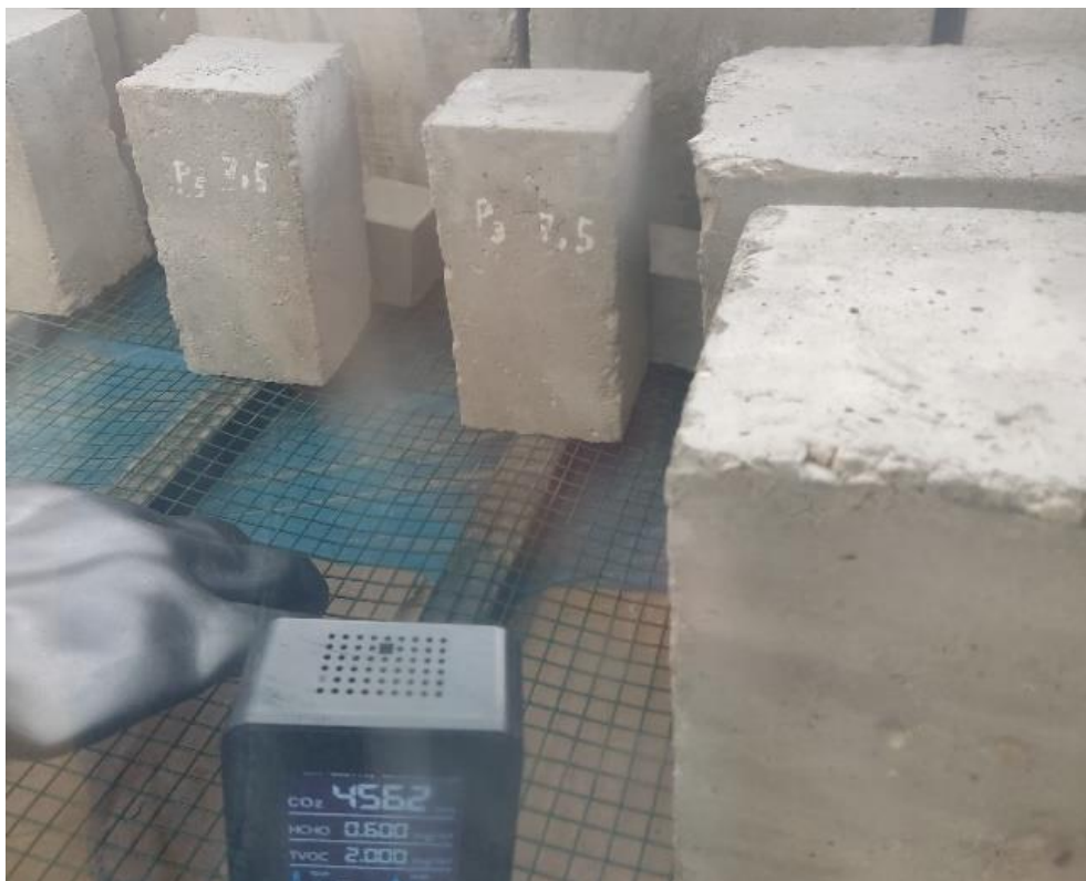
Figura 27 Concentración de CO 2 dentro de la cámara de carbonatación acelerada.
