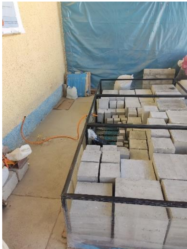
Figura 29 Fin del proceso de carbonatación acelerada.
