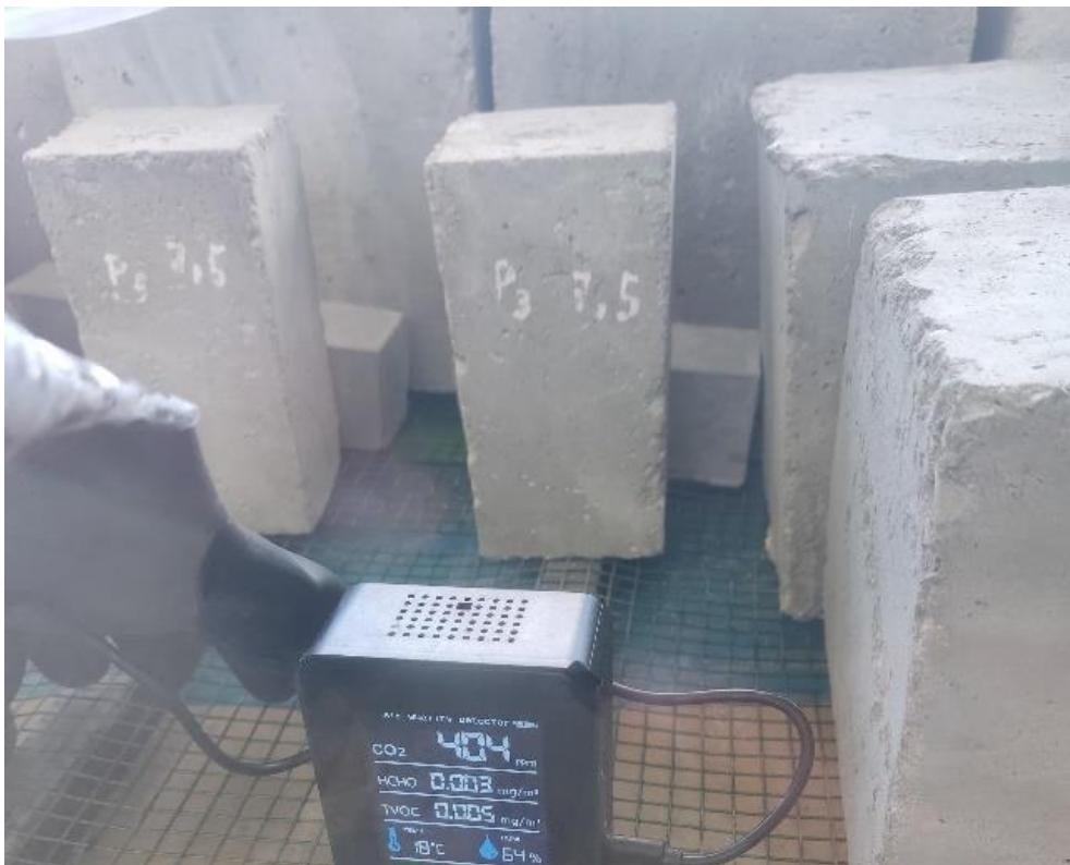
Figura 25 Sensor de CO 2 y humedad relativa y temperatura.
