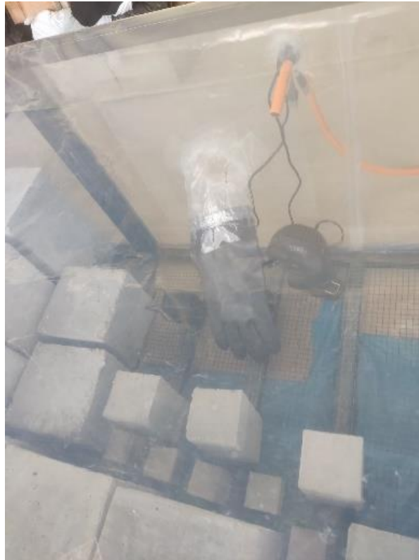
Figura 25 Sensor de CO 2 y humedad relativa y temperatura.
