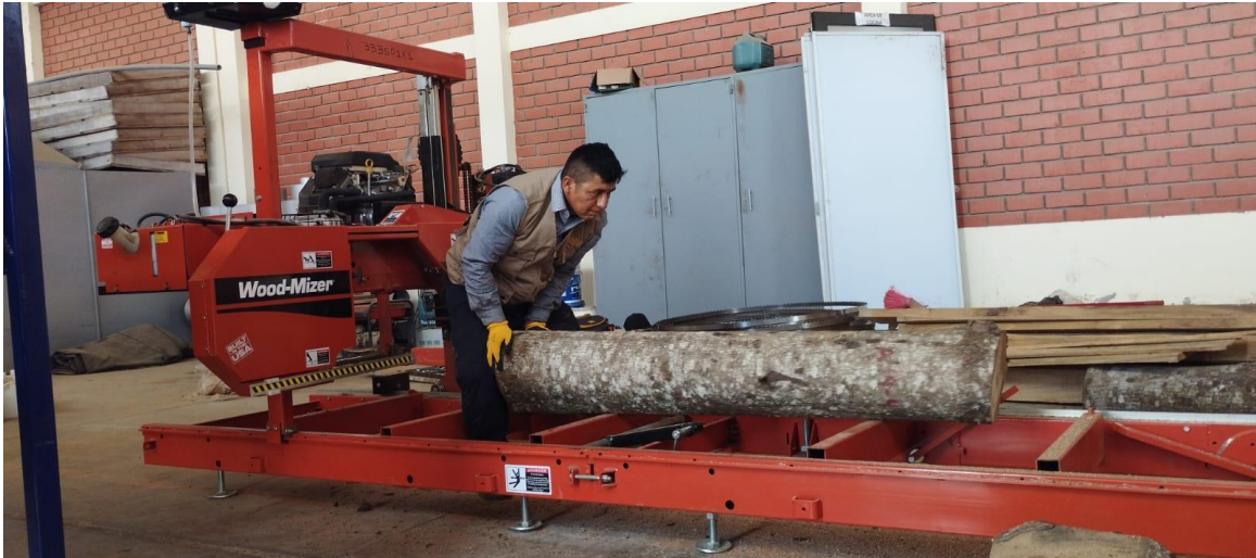
Foto 4. Aserrió de trozas de Cordia alliodora en aserradero portátil
