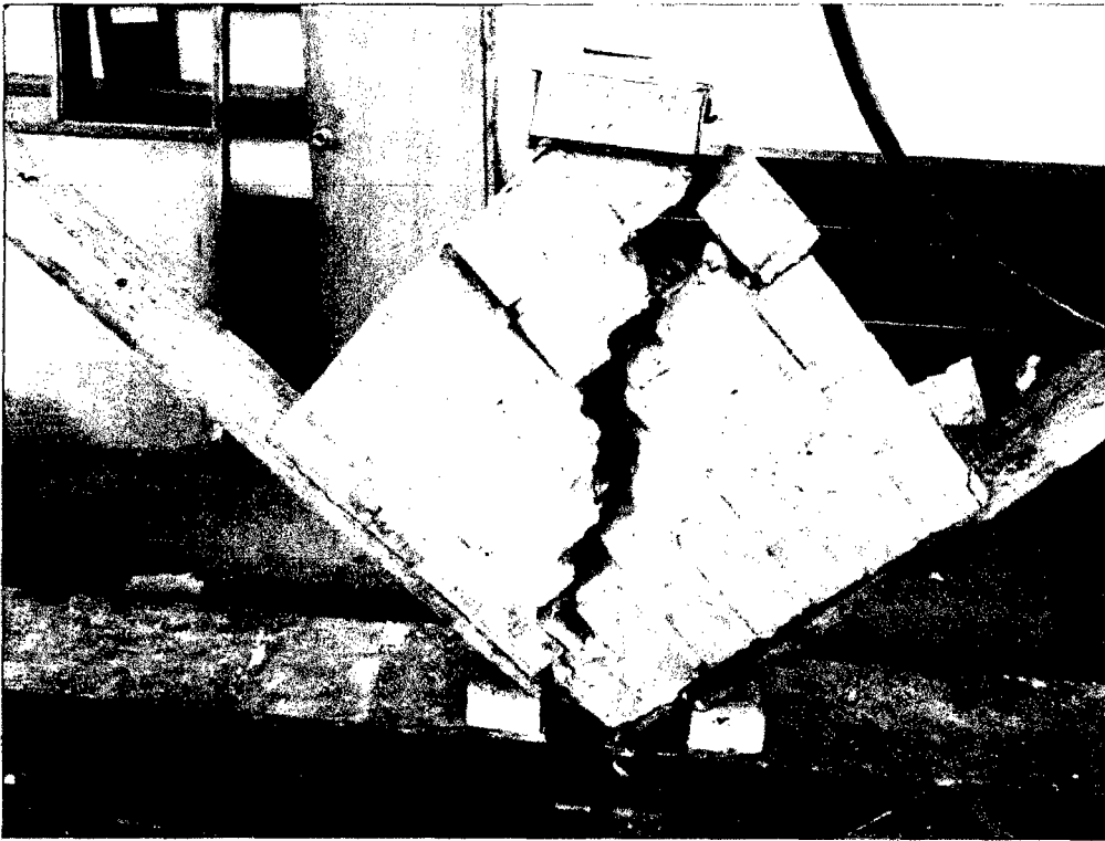
Imagen 4.6. Falla de uno de los muretes del los prototipos del ladrillo alternativo sin cocción de suelo-cemento.
