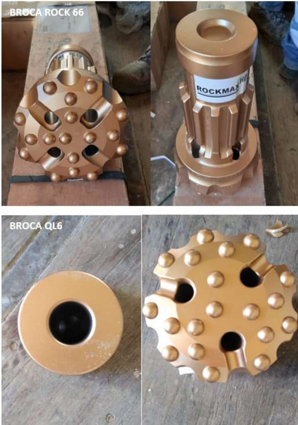
Figura 44. Broca ROCK 66 vs QL6, sistema de barrido y diseño de insertos.
