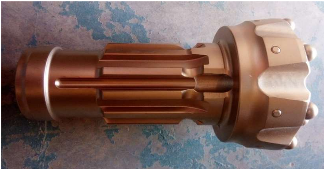
Figura 43. Broca QL6 6 \frac{3}{4} ", estructura de conexión.
