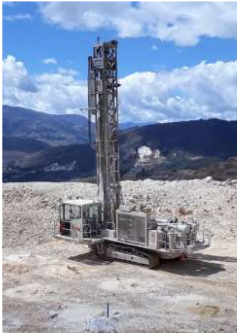
Figura 33. DM45 - 01 usando el martillo y broca ROCK 66 en el QSD.
