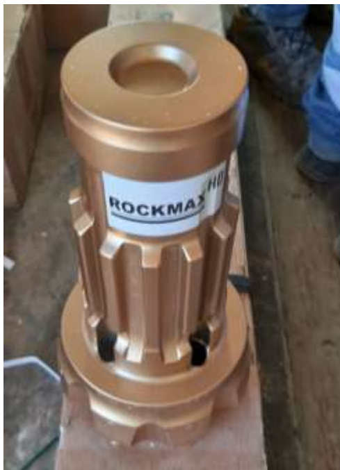
Figura 37. Broca ROCK 66 6 \frac{3}{4} " con sistema de barrido externo de 4 orificios.
