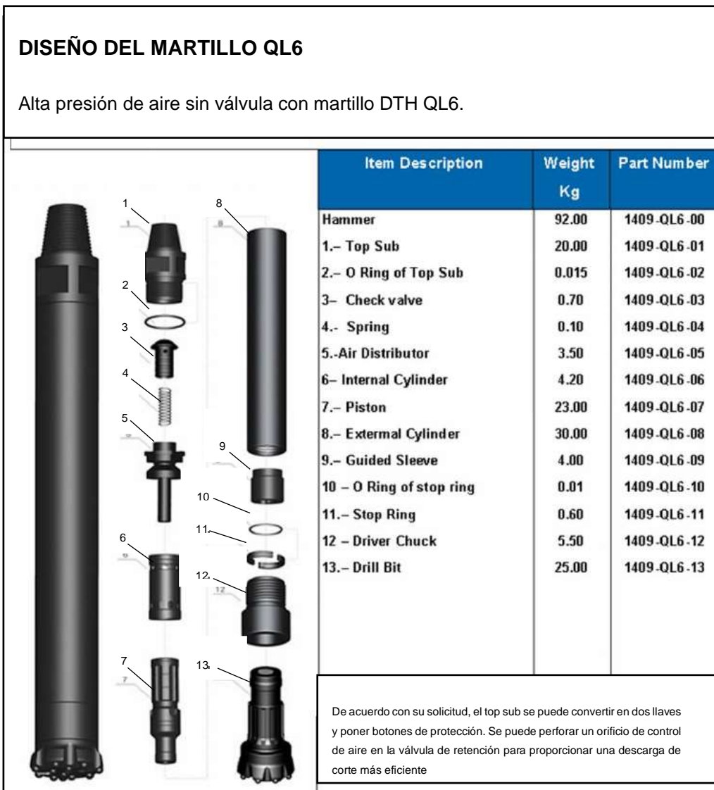
Figura 25. Diseño del martillo QL6.
