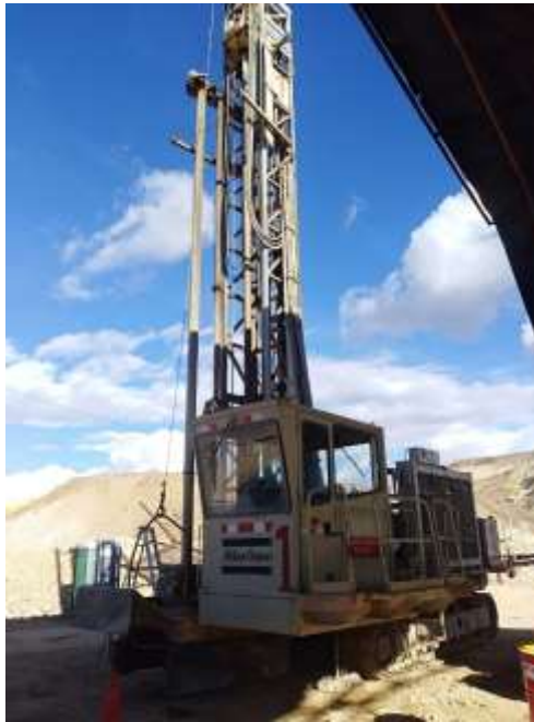
Figura 32. Perforadora de prueba DM45 - 01.
