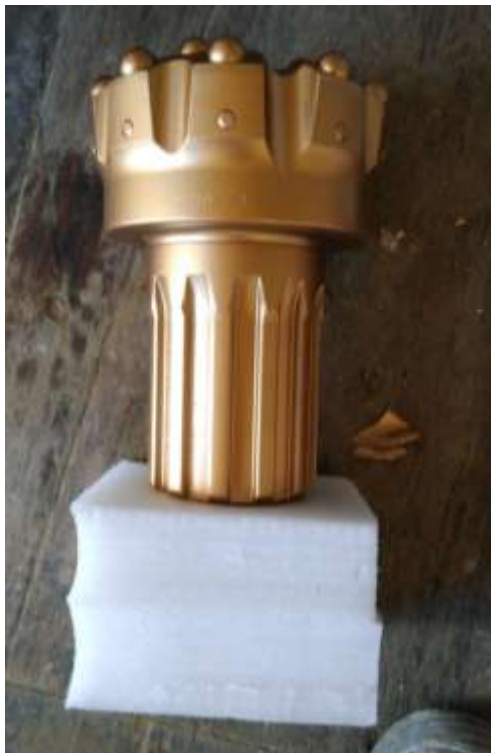
Figura 41. Sistema de barrido de la broca QL6 sin orificios en los costados.
