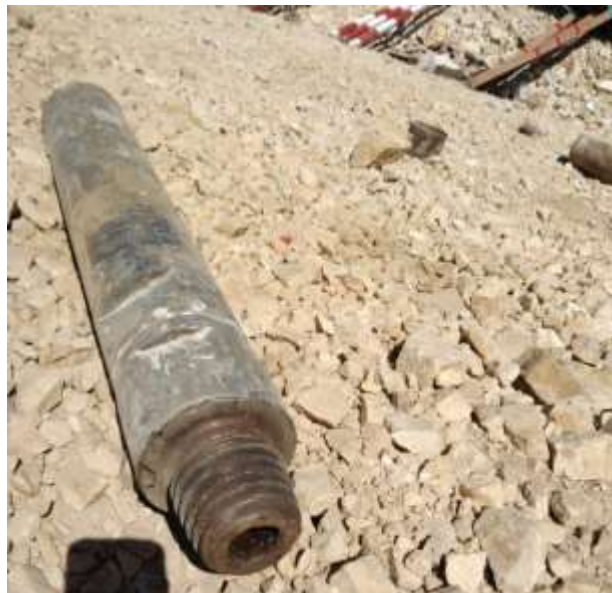
Figura 35. Martillo Rock 66 PIN BOX para conectarse a la barra.
