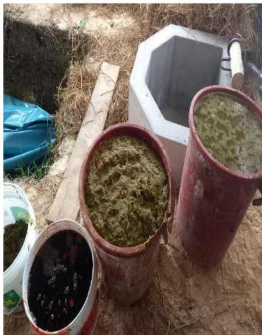
Figura 16. Carga del biodigestor
